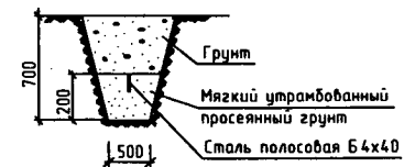
Установка горизонтальных заземлителей
